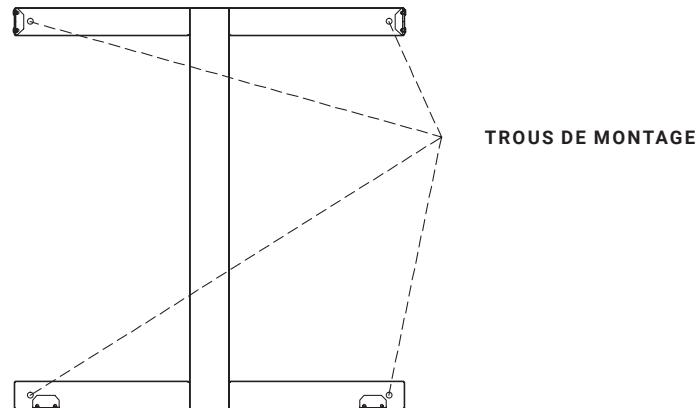
**2.2** Percez les quatre trous marqués à l'aide d'un foret de 8 mm. Insérez les chevilles en plastique dans les trous. Si le mur est en bois massif, il n'est pas nécessaire de percer les trous ou d'utiliser les chevilles en plastique. Fixez maintenant le support mural avec 4 vis (ST5 x 40).
