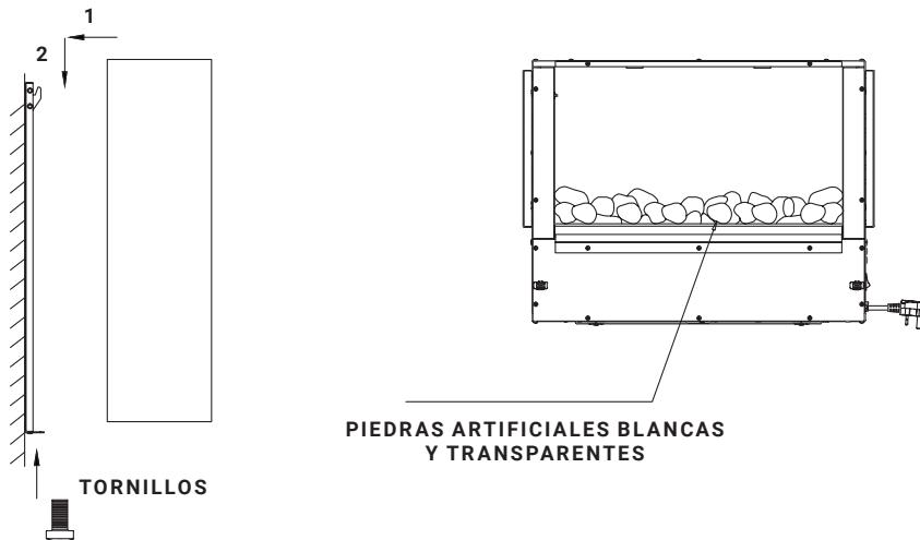
**2.4** Cuelgue la lámina de vidrio en la cámara de combustión, presione el frontal del vidrio y fíjelo a la parte superior del hogar con 2 tornillos (M4 x 8).
