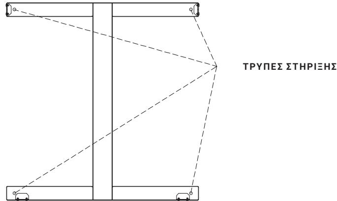
**2.2** Ανοίξτε τις τέσσερις σημειωμένες οπές με τη βοήθεια ενός τρυπανιού 8mm. Τοποθετήστε χτυπώντας τα ούπατ στις οπές. Εάν ο τοίχος είναι κατασκευασμένος από μασίφ ξύλο δεν είναι απαραίτητη η διάνοιξη οπών ή η χρήση πλαστικών ούπατ. Τώρα στερεώστε την επίτοιχη βάση με 4 βίδες (ST5x40).
