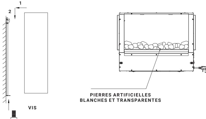
**2.4** Accrochez la vitre à la chambre de combustion, appuyez sur la vitre et fixez la façade au sommet de la chambre de combustion à l'aide de 2 vis (M4 x 8).
