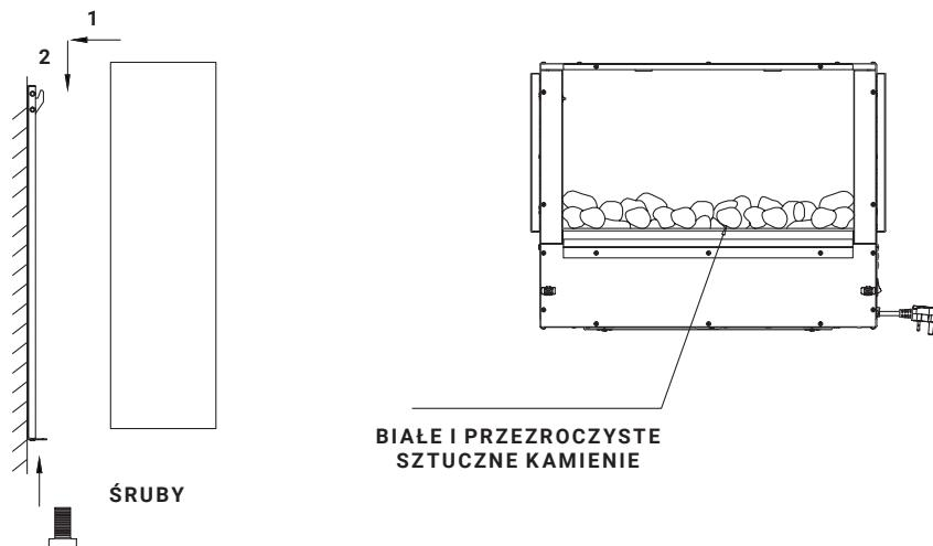
**2.4** Zawiesić panel szklany na komorze spalania, wcisnąć front szklany i przymocować front do górnej części komory spalania za pomocą 2 śrub (M4 x 8).
