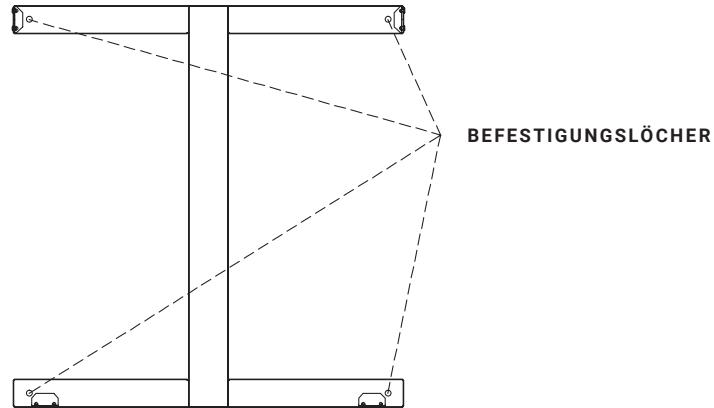
**2.2** Bohren Sie die vier angezeichneten Löcher mithilfe eines 8 mm Bohrers. Klopfen Sie die Kunststoffdübel in die Löcher. Wenn die Wand aus massivem Holz besteht, ist es nicht notwendig, die Löcher zu bohren oder die Kunststoffdübel zu verwenden. Befestigen Sie nun die Wandhalterung mit 4 Schrauben (ST5 x 40).
