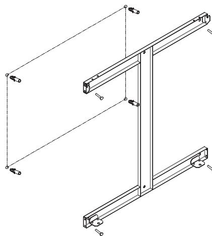
**2.3** Αναρτήστε τον θάλαμο φωτιάς στη βάση και στερεώστε τον με 2 βίδες (M5x10) στο κάτω μέρος του θαλάμου. Τοποθετήστε στο EF159P το διακοσμητικό υλικό όπως επιθυμείτε, κατά μήκος του πυθμένα της φλόγας.
