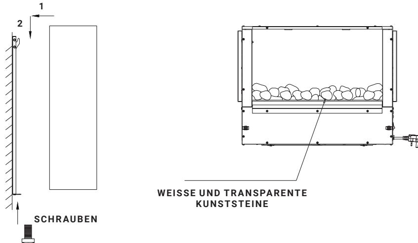
**2.4** Hängen Sie die Glasfront an die Brennkammer, drücken Sie die Glasfront an und befestigen Sie die Front mit 2 Schrauben (M4 x 8) an der Oberseite der Brennkammer.
