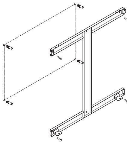
**2.3** Appendere la camera di combustione alla staffa e fissarla alla parte inferiore della stessa camera di combustione con 2 viti (M5 x 10). Con l'EF159P il materiale decorativo può essere disposto a piacimento, lungo la griglia del caminetto.
