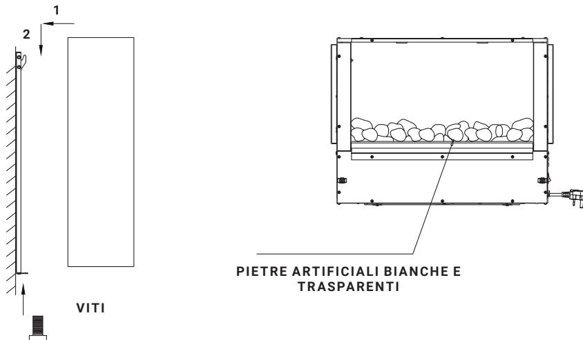
**2.4** Appendere la lastra di vetro alla camera di combustione, premere il pannello in vetro e fissare la parte anteriore con 2 viti (M4 x 8) alla parte superiore della camera di combustione
