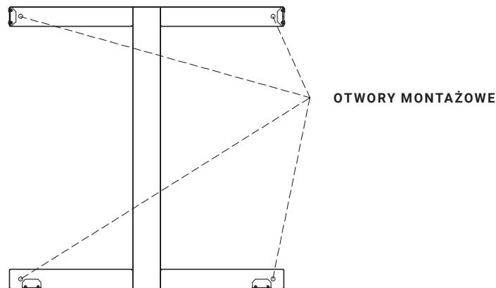
**2.2** Wywiercić cztery otwory w zaznaczonych miejscach za pomocą wiertła o średnicy 8 mm. Wcisnąć kołki rozporowe do otworów. Jeżeli ściana wykonana jest z litego drewna, nie ma potrzeby wiercenia otworów ani stosowania kołków rozporowych. Przymocować uchwytścienny za pomocą 4 śrub (ST5 x 40).
