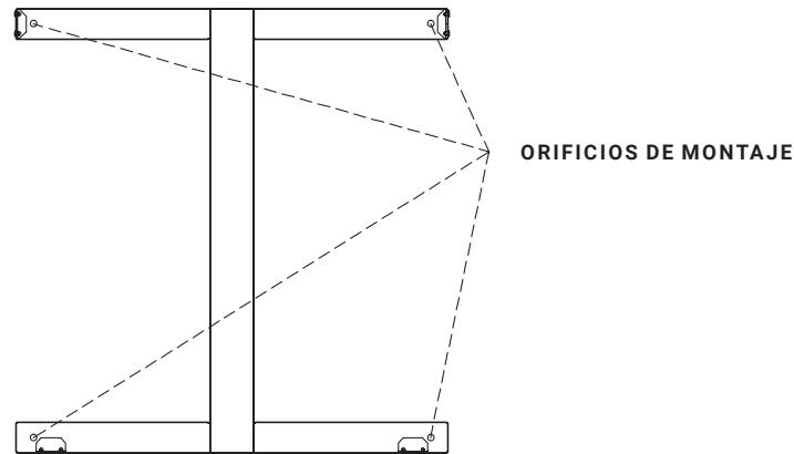
**2.2** Taladre los cuatro orificios marcados con una broca de 8 mm. Inserte los tacos de plástico en los orificios. Si la pared es de madera maciza, no es necesario taladrar los orificios ni utilizar los tacos de plástico. Ahora fije el soporte de pared con los 4 tornillos (ST5 x 40).
