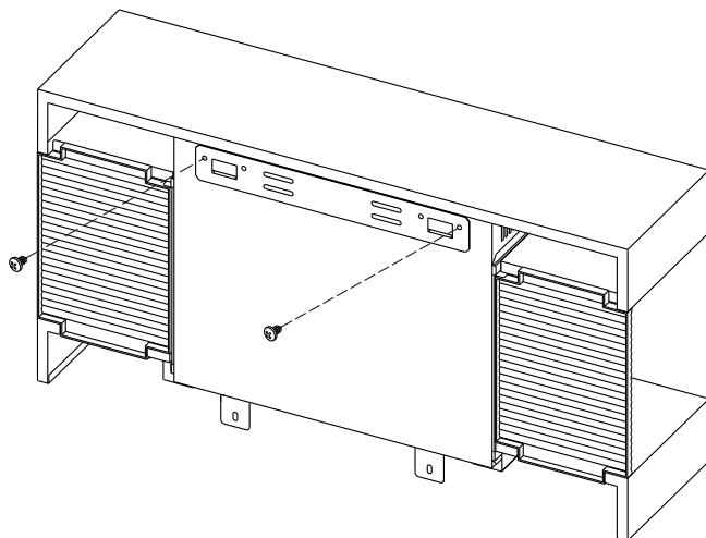
Τοποθετήστε το επίτοιχο στήριγμα στην επιθυμητή θέση, εξασφαλίζοντας ότι το στήριγμα είναι επίπεδο. Σημειώστε και τρυπήστε τα σημεία fivarnmolόγησης, βιδώστε τα βύσματα τοίχου στις οπές και στερεώστε το στήριγμα στον τοίχο με 4x βίδες ST5\*40.
