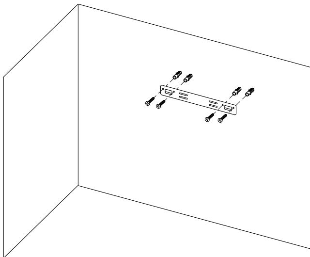
Ανασηκώστε τη συσκευή και στερεώστε τη στηριγμάτων, σημειώστε τη θέση των οπών των δύο κάτω fiaξονικών στηριγμάτων, κατεβάστε τη συσκευή, ανοίξτε οπές στα σημάδια και, στη συνέχεια, τοποθετήστε βύσματα τοίχου σε αυτά.
