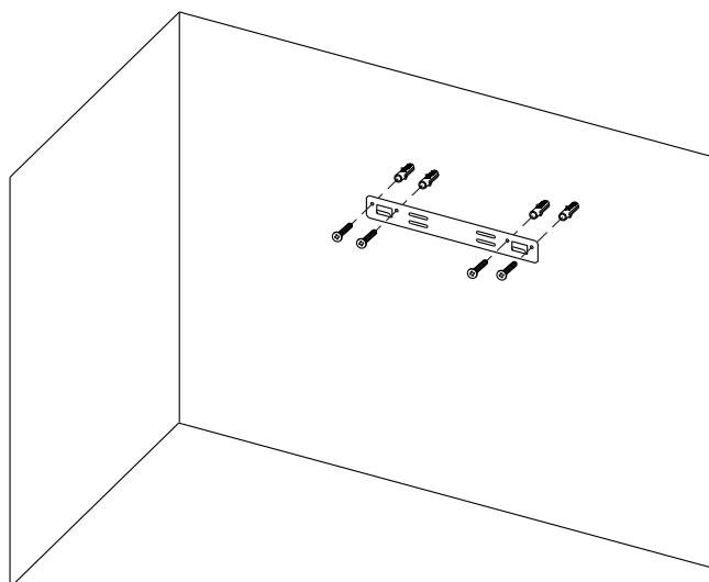
Podnieś urządzenie i przymocuj do wspornika sciennego, zaznacz położenie otworów dwóch dolnych wsporników mocujących, zdejmij urządzenie, wywierc otwory w oznaczeniach, a następnie włóż do nich kołki rozporowe.
