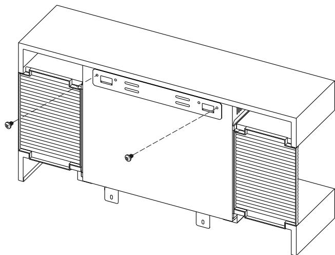
Coloque el soporte mural en la posición deseada asegurándose de que esté nivelado. Marque y taladre los puntos de fijación, introduzca los tacos en los orificios y fije el soporte a la pared con 4 tornillos ST5\*40.
