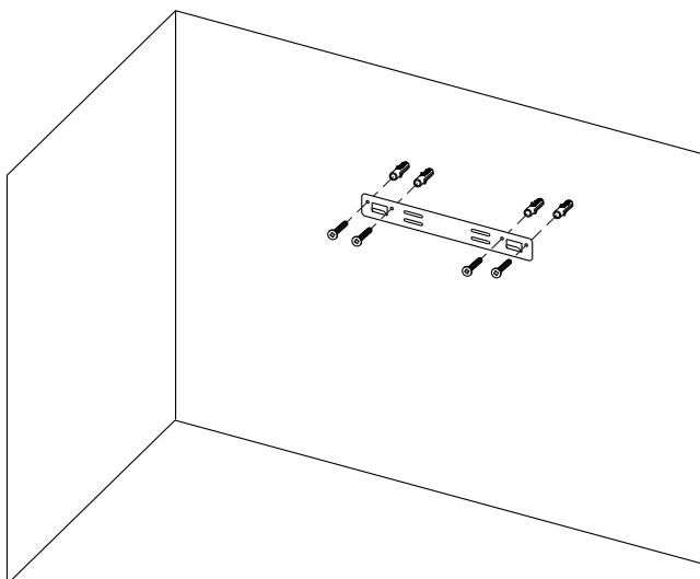
Soulevez l'appareil et fixez-le au support mural, marquez la position des trous des deux supports de fixation inférieurs, abaissez l'appareil, percez les trous sur les marques et insérez les chevilles dans les trous.
