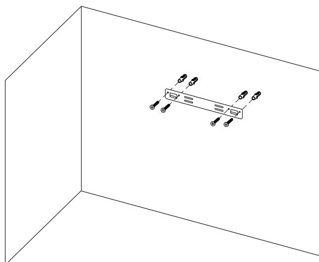
Levante el aparato y fíjelo al soporte de pared, marque la posición de los orificios de los dos soportes de fijación inferiores, baje el aparato, taladre los orificios en las marcas e inserte los tacos en ellos.
