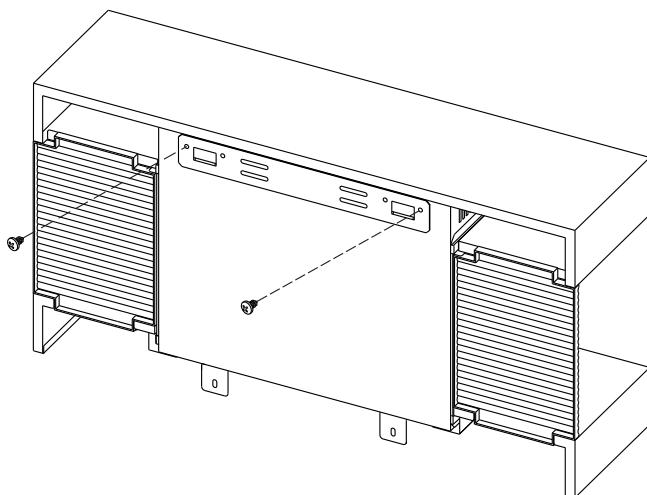
Placez le support mural dans la position souhaitée en veillant à ce qu'il soit de niveau. Marquez et percez les points de fixation, enfoncez les chevilles dans les trous et fixez le support au mur à l'aide de 4 vis ST5\*40.
