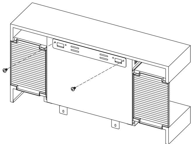
Posizionare la staffa a parete nella posizione desiderata, assicurandosi che la staffa sia in piano. Segnare e forare i punti di fissaggio, inserire i tasselli nei fori e fissare la staffa alla parete con 4 viti ST5\*40.
