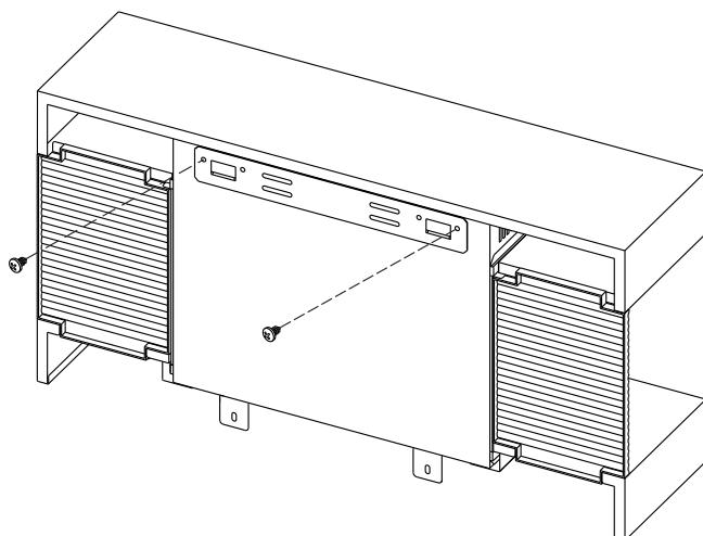
Bringen Sie die Wandhalterung in der gewünschten Position an und achten Sie darauf, dass die Halterung eben ist. Markieren und bohren Sie die Befestigungspunkte, schlagen Sie Dübel in die Löcher und befestigen Sie die Halterung mit 4x ST5\*40-Schrauben an der Wand.
