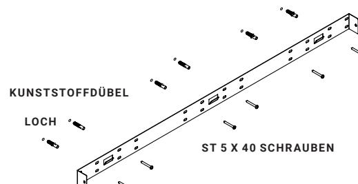
**2.3** Hängen Sie die Elektroseinheit ein und fixieren Sie diese an beiden Seiten mit den jeweiligen Schrauben.
