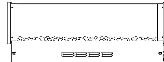
**2.5** Hängen Sie die Frontglasscheibe ein und sichern Sie diese mit zwei ST4X10 Schrauben.
