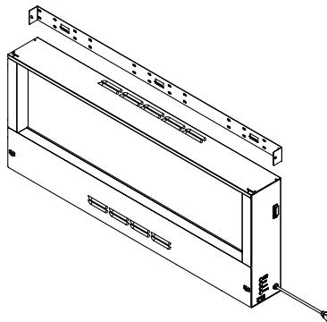
**2.2** Retire el soporte y taladre 6 orificios de ø8 en la pared. Inserte los tacos de plástico en los orificios. Si la pared es de madera maciza, no es necesario taladrar los orificios ni utilizar los tacos de plástico. Ahora, fije el soporte de pared con los 4 tornillos (ST5x40).
