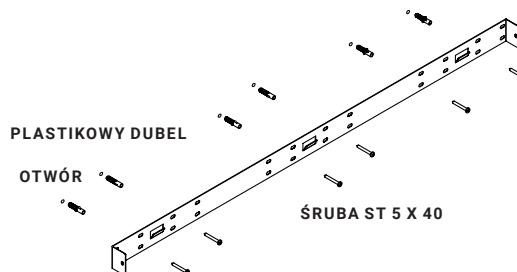
**2.3** Zawieś jednostkę elektryczną i przymocuj ją z obu stron za pomocą odpowiednich śrub.
