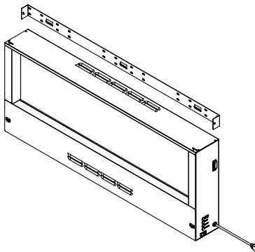
**2.2** Αφαιρέστε τη βάση στήριξης και ανοίξτε 6 οπές Φ8 στον τοίχο. Τοποθετήστε χτυπώντας τα ούπατ στις οπές. Εάν ο τοίχος είναι κατασκευασμένος από μασίφ ξύλο δεν είναι απαραίτητη η διάνοιξη οπών ή η χρήση πλαστικών ούπατ. Τώρα στερεώστε την επίτοιχη βάση με 4 βίδες (ST5x 40).
