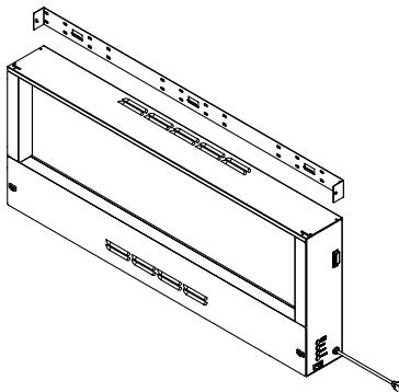
**2.2** Zdejmij wspornik i wywierć w ścianie 6 otworów  $\Phi 8$ . Wbij plastikowe kołki w otwory. Jeśli ściana jest wykonana z litego drewna, nie ma potrzeby wiercenia otworów ani używania plastikowych dubli. Przymocuj wspornik ścienny za pomocą 4 śrub (ST5 x 40).
